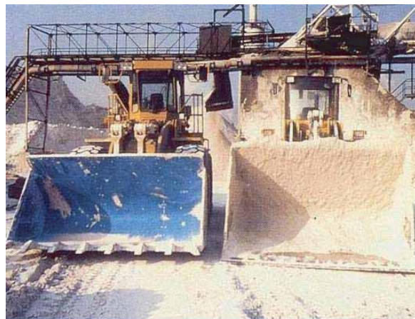
Применение футеровки TIVAR 88 для покрытия ковша позволяет ликвидировать проблему налипания гипса (по сравнению с обычным ковшом).
