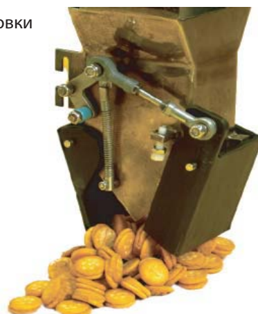
Заслонки короба снижают шум и минимизируют скопление продукта. TIVAR® CleanStat снижает ударное воздействие на печенье.
