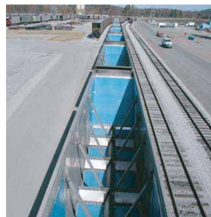
Применение футеровки TIVAR 88 для покрытия наклонных стенок вагонов для перевозки угля (сверху) и кузова самосвала (слева).
