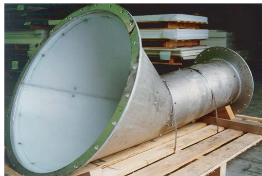
Труба и конус покрыты TIVAR® H.O.T.
